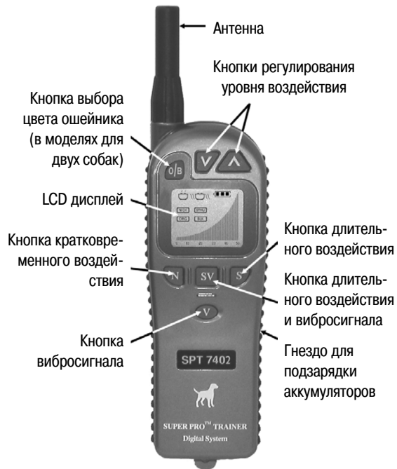
Передатчик (показан SPT 7402, вид других моделей может несколько отличаться)
